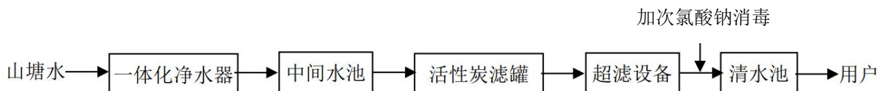
图 2-1 一体化净水器生产流程示意图
